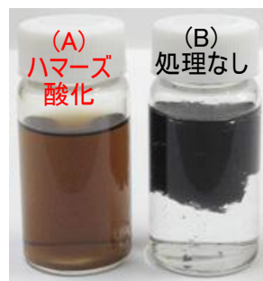
図3. 長尺SWCNTのアルコール中での分散状態
